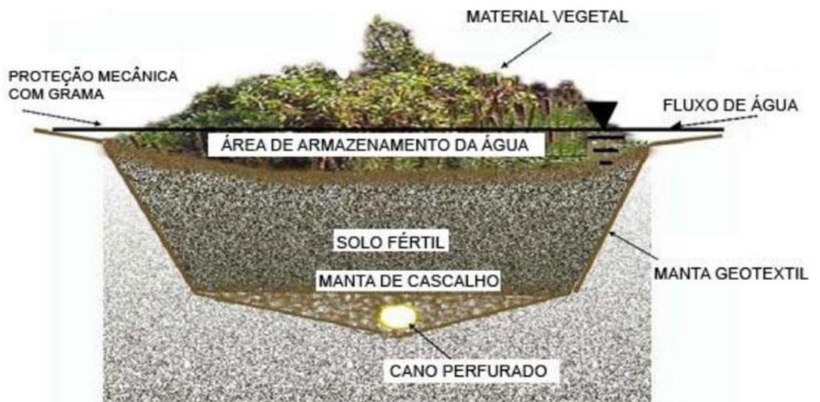
Figura 31: corte de um jardim de chuva, adaptado de Liliane Bertoldi
