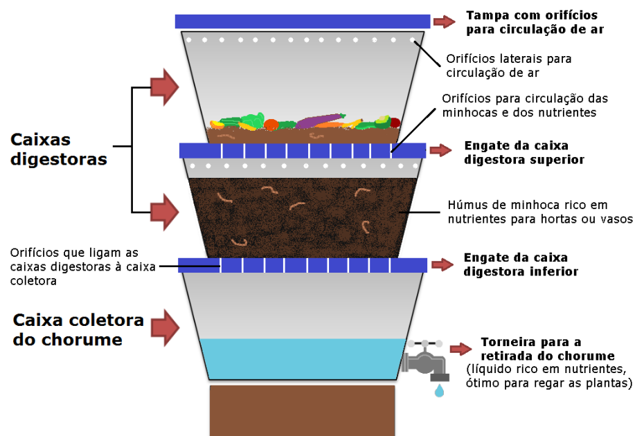
Figura 30: diagrama de montagem de uma composteira
